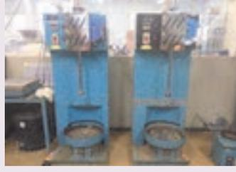
締固め試験
