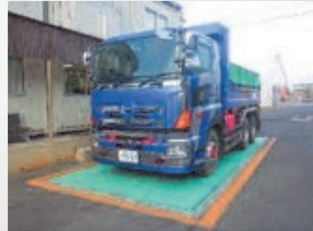
ピット埋込型トラックスケールによる計量
